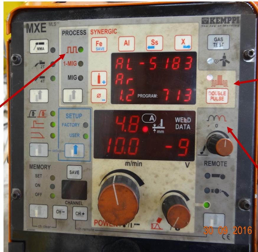
Le pulsé « mécanique » permet d'obtenir des paramètres alternativement chauds et froids, comme en TIG, par le réglage d'une fréquence, ou par tous les paramètres recomposés (ce qui est plus difficile à régler). Sur ce poste le pulsé est non réglable. Ce pulsé donne une meilleure tenue du bain en position et une pénétration plus forte.
